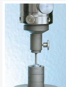
Test Restnietdornverriegelung Mandrel retaining test Essai de résistance au désassemblage de la tige
