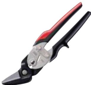
Handblechscheren mit Hebelübersetzung bestehen aus Scherenkopf und Griff. Beide Teile sind für sich gelenkig gelagert, so dass sich eine zusätzliche Hebelübersetzung ergibt.
